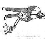
Controllare che il canale di lubrificazione della lama non sia ostruito. Pulire se necessario.
